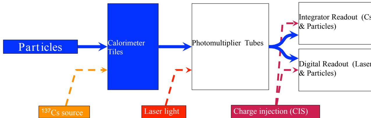
$$E_{channel} = A \cdot C_{ADC \rightarrow pC} \cdot C_{pC \rightarrow GeV} \cdot C_{Cs} \cdot C_{laser}$$
