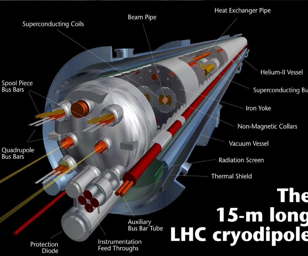
The **15-m long LHC cryodipole**
